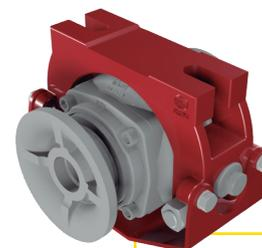
**Mancal DUROMARK OSCILANTE® (DMO):** possui suporte de oscilação, que permite que as seções de discos girem mais livremente, reduzindo o esforço e conseqüentemente o consumo de combustível do trator, além de aumentar a durabilidade dos componentes internos do mancal e possuir encaixes que permitem a fácil montagem e desmontagem. São equipados com rolamentos de rolos cônicos e retentores Duo-Cone com lubrificação permanente a óleo.
