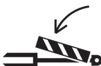
Sempre utilizar as travas para efetuar a manutenção e o transporte dos equipamentos.
