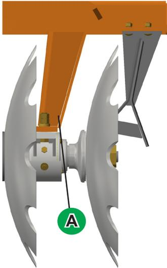
Na fixação das seções, as sapatas (A) devem permanecer voltadas à concavidade dos discos.
