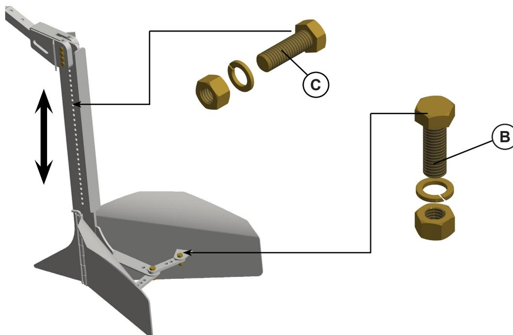
As hastas sulcadoras tem ajustes de profundidade na abertura das canaletas, ou seja, solte o parafuso (C), arruela de pressão e porca e mova para o furo desejado.
