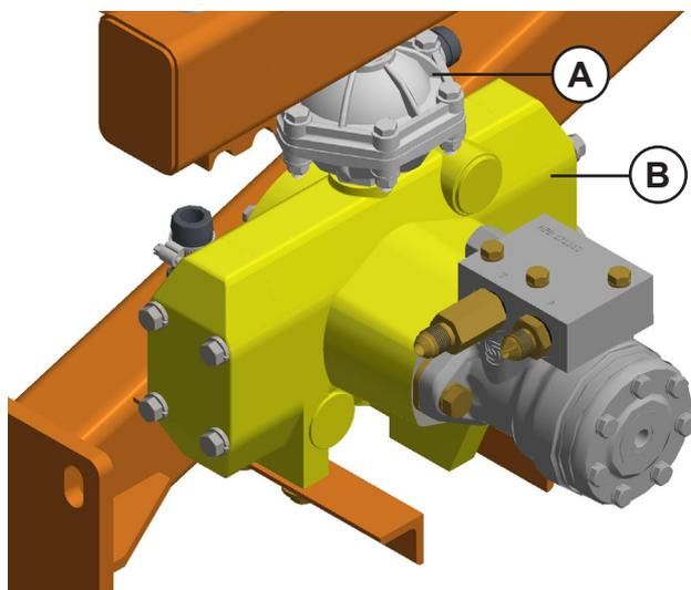
O anti pulso (A) é fabricada com pré-carga e selada.
