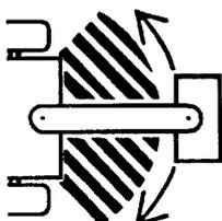
Não transite em rodovias ou estradas pavimentadas. Nas curvas fechadas, evite que as rodas do trator toquem o cabeçalho.
