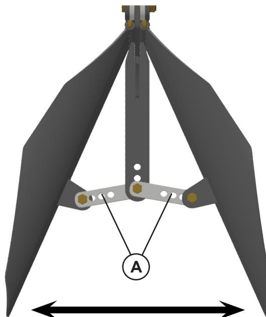
Para abertura ou fechamento do sulco deve soltar o parafuso (B) e posicionar a barra de regulagem (A) nos furos desejados.
