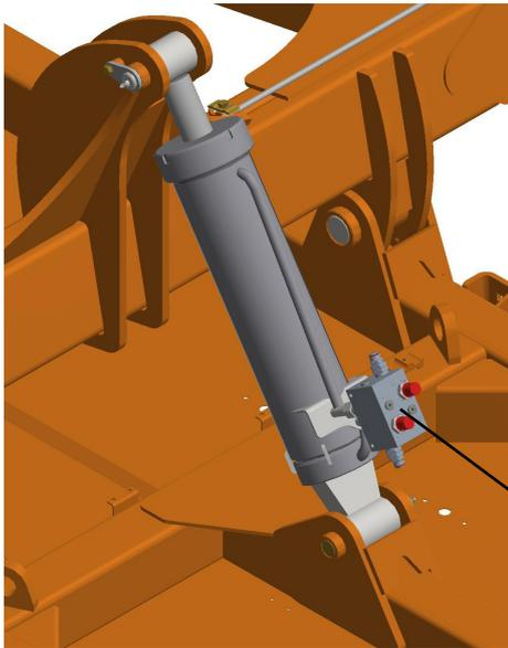
O cilindro do rodeiro de transporte também possui válvula de contrabalanço (A), porém é dupla, ou seja, tem dupla função. Em caso de despressurização do circuito hidráulico com o rodeiro acionado em modo de transporte, a válvula mantém o compostador elevado para que ele não venha a causar acidentes deixando o equipamento cair. Já na posição de descansado (cilindro recolhido) em caso de despressurização, a válvula impossibilita a movimentação (cair) pela ação da gravidade, evitando acidentes
